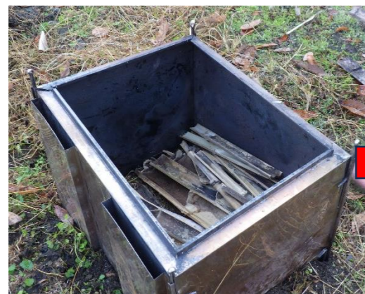
まずは炭材(竹)を詰め込みましょう ※乾燥している方が着火は早くなります
