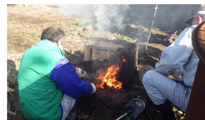
こんなに燃えて大丈夫?これは精錬(せいれん)の様子です。炭焼きの終わり頃に空気を大量に入れ、高温で処理する作業で、その後は窯出しまで密閉します
