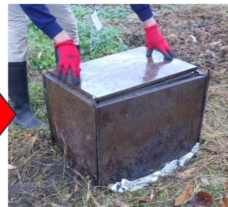
蓋をかぶせます ※付属のピンがあり、4か所固定
